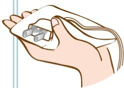
コンセントに差しっぱなしなうえ、手が届きにくく掃除しにくい調理家電の電源プラグ。しかし、コンセントとプラグの間にたまったホコリが湿気を帯びると、電気が流れて熱を発生し、ついには発火(トラッキング現象)することもあります。時々プラグを抜いて、感電しないよう乾いた布で丁寧にホコリを取りましょう。調理家電のほか、洗面所などの家電も忘れずに。
